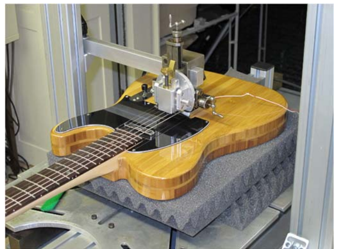
Abbildung 8: E-Gitarre mit Korpus aus Mosobambus auf einer Apparatur zur Sustain-Messung
