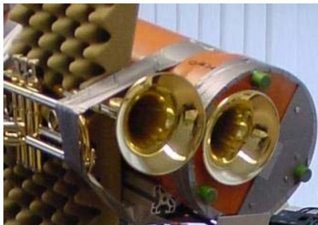
Abbildung 3: : Zwei typgleiche Trompeten, die rechte steckt spielbereit in einem mit Sand gefüllten PVC – Rohr
