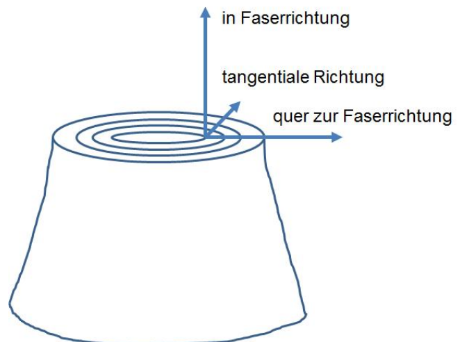
Abbildung 4: Eigenschaftsrichtungen (Orientierungsrichtungen) im Holz
