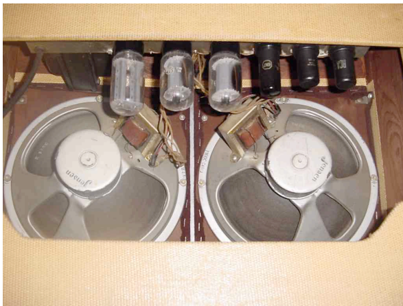
Fig. 13. Fender Dual Professional von 1947; mit 2 Ausgangsrafos an den Speakern, und 3 Reglern ( https://courses.physics.illinois.edu/phys406/sp2017/406emi_fender_amps.html )
