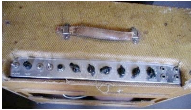
Fig. 5. Links: Bassman 5D6: 2 Gleichrichter-Röhren, 4x10"-Speaker, 2 Eingänge, T-B-P-Klangregelung, ( https://www.thegearpage.net/board/index.php?threads/1954-5d6-bassman.843169/ ). Rechts: Bedienpanel des Bassman 5F6-A: 4 Eingänge, T-M-B-P-Klangregelung, ( http://www.trinaamp.altervista.org/FenderBassman5F6ATweed.htm ).
