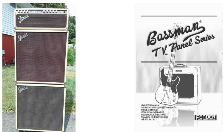
Fig. 11. Links: der Rumble Bass (1994, https://www.talkbass.com/threads/who-here-wants-to-rumble-fender-custom-shop.1231450/ ) aus dem Custom Amp Shop kombiniert alles, was die Tradition an Feinem zu bieten hat mit 300 W Röhren-Power, umfassender Klanregelung und viel Membranfläche aus 2x4x10"-Speakern. Rechts: die (rein kosmetische) Rückkehr zu den Anfängen: um 2010 bietet Fender einen TV-Front Bassman an - aber mit nur einer einzigen 7025-Vorstufen-Röhre: die Leistung kommt von Transistoren ( https://www.fmicassets.com/Damroot/Original/10001/OM_leg_bassamp_Bassman_TV_Amps_20092012.pdf ).
