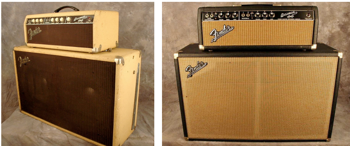
Fig. 9. Links: 1962'er Bassman - jetzt im Piggy-Back-Design und mit geschlossener 2x12"-Box (hier mit den optionalen JBL-Speakern) - beachte die praktischen Schrägsteller. Amp und Box konnten mittels Schnellverschluss miteinander verschraubt werden Rechts: Blackface-Bassman von 1965 - die Presence-Regelung wurde durch den Bright-Switch "ersetzt". (Fotos © 2018 Ron's Vintage, mit freundlicher Genehmigung, http://www.ronsvintage.com/1952-Bassman-Amp.htm ).
