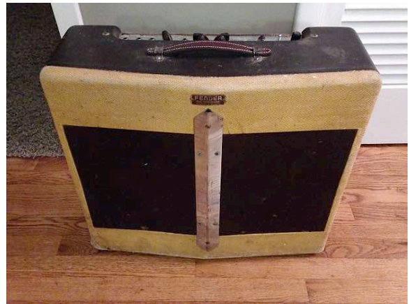
Fig. 13. Fender Dual Professional von 1947; mit 2 Ausgangsrafos an den Speakern, und 3 Reglern ( https://courses.physics.illinois.edu/phys406/sp2017/406emi_fender_amps.html )
